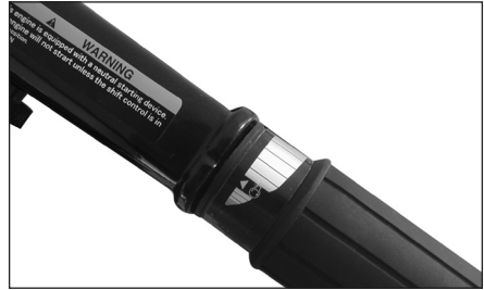
Рис.3 Рукоятка управления дроссельной заслонкой
